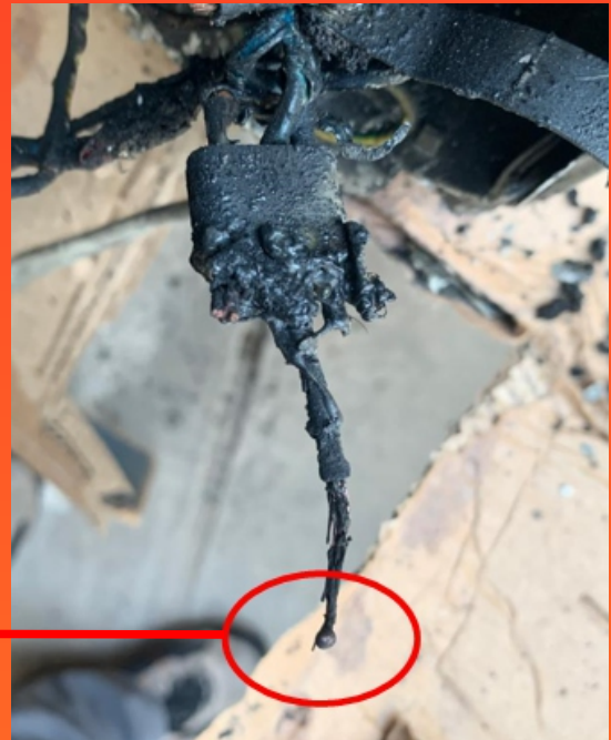
Traço de fusão primário, com descoloração do condutor..
