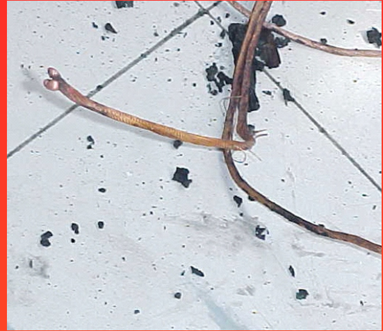
Traço de fusão primário, com descoloração do condutor..
