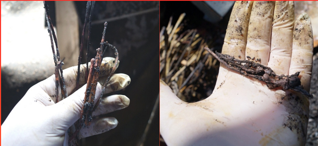
Traços secundários possuindo resíduos de carbonetos e superfícies ásperas.
