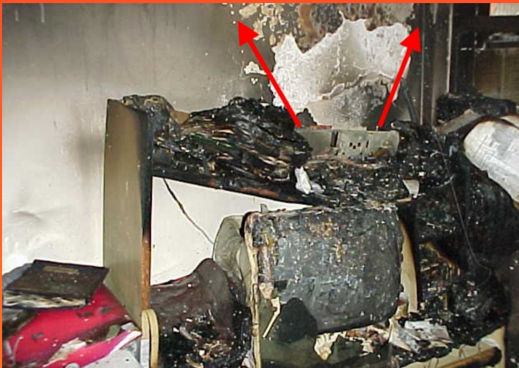
Delineamento em forma de cone invertido evidenciando o foco no equipamento (impressora).
