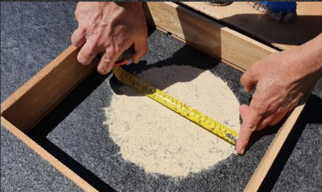
A areia utilizada no ensaio deve estar uniformemente limpa e seca, com grãos em formato esférico, que passam pela peneira de abertura de 0,18mm (80 Mesh) e ficam retidos na peneira com abertura de 0,15mm (100 Mesh). Essa areia foi preparada no Laboratório de Física dos Solos do Departamento de Solos da Universidade Federal Rural do Rio de Janeiro.
