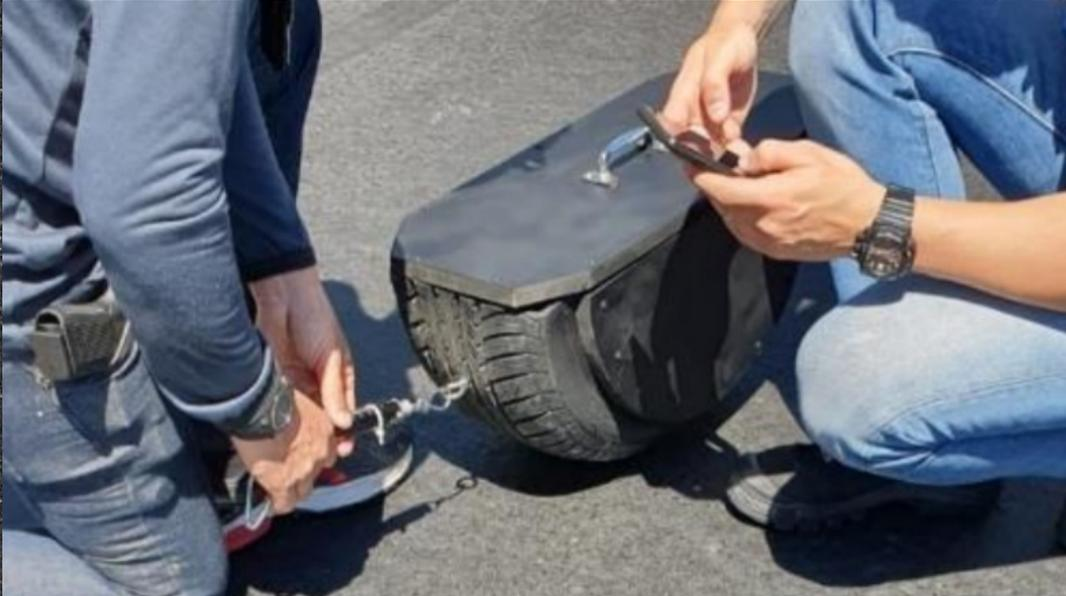
O princípio de funcionamento do *dragsled* é da seguinte forma: o equipamento é puxado com uma velocidade constante, próximo ao local onde se deu o acidente de trânsito ou, se possível, no mesmo local, e o valor referente à força com que o *dragsled* é puxado, é lido no dinamômetro.
